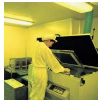
**Расстояние до трафарета** - расстояние от лампы до трафарета в значительной степени влияет на время экспонирования, так как с увеличением дистанции интенсивность освещения очень быстро снижается. Например, трафарет, который экспонируется за 30 секунд при расстоянии 1,0 м с увеличением дистанции до 2,0 метров необходимо будет экспонировать уже 900 секунд. Важно: чем дальше расположен источник света от трафарета, тем меньше искажение по краям изображения.
